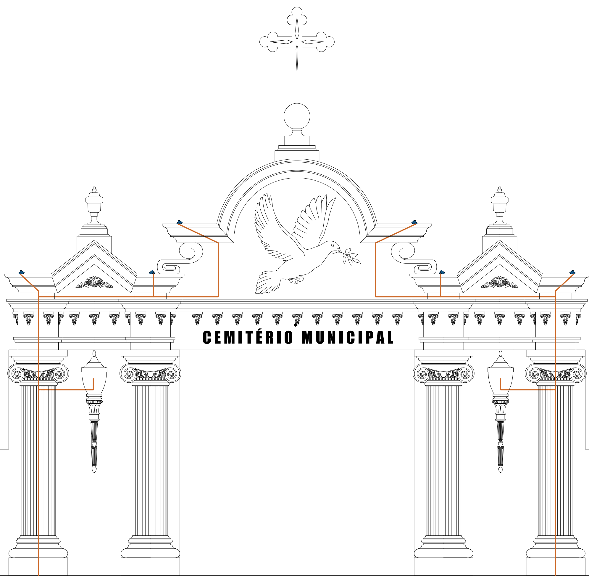
ELEVAÇÃO FRONTAL - ESQUEMA ELÉTRICO Esc. 1/50
